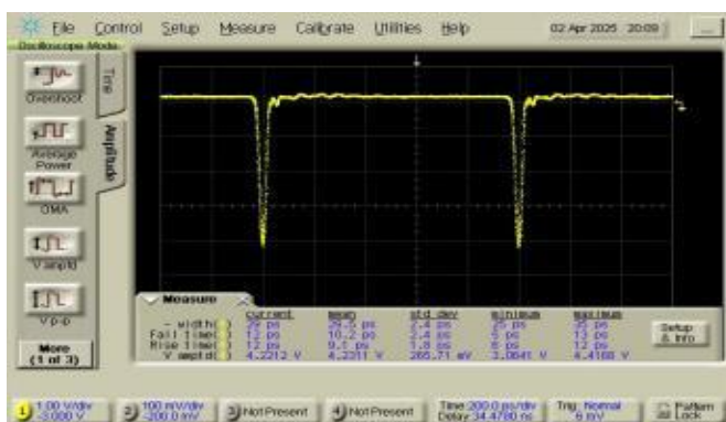
30ps 脉宽 @ 时钟频率: 1GHz, 输出电平 4.2Vpp
