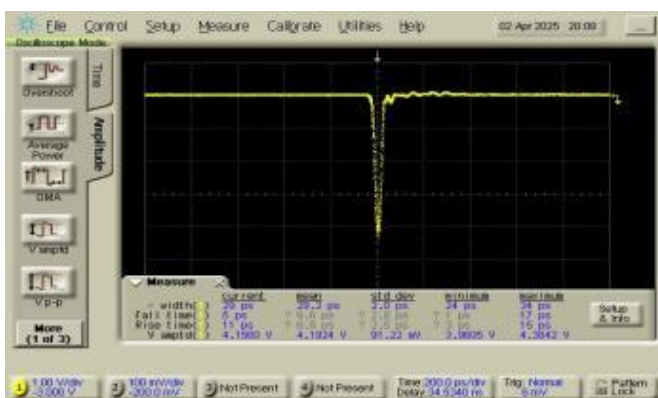
30ps 脉宽 @ 时钟频率: 100kHz, 输出电平 4.1Vpp
